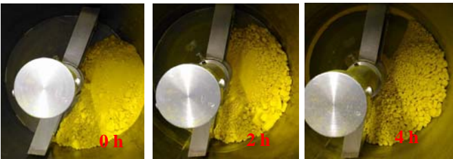
圖十二、低速乾燥機滾筒內部未架設刮刀且未使用二氧化鋁球進行球磨細化，脫水後結塊碳粉於加熱溫度 50°C、不同持溫時間後之外觀型態圖。
