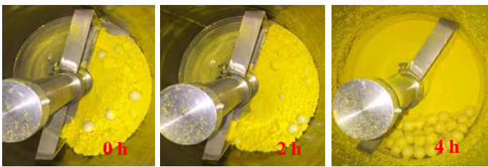
圖十一、低速乾燥機滾筒內部未架設刮刀，脫水後結塊碳粉於加熱溫度 50°C、不同持溫時間後之外觀型態圖。
